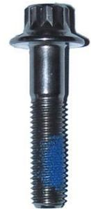
如果涂装时旋转螺钉，就可以360°涂上聚酰胺涂层。这不仅可以卡住螺纹，而且同时起到密封效果 - 这种螺钉的设计对密封容器的安装非常重要。聚酰胺涂层可以直接作业于有效部位，即外螺纹或内螺纹啮合之处。涂层厚度可以在一定程度上做相应调整，并可由此产生有效力矩的效果。通常预留出螺纹端的2-3个螺牙不需要涂层。这样螺钉锁入对手件时就不会出现问题。有效力矩螺钉通常用作调节螺钉。
