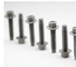
即使装配部件发生强烈振动，螺纹面也不会出现相对滑动。完全可以保持现有的螺纹摩擦力，从而可避免使用额外的锁紧装置。即使在拆卸和重新装配后，仍然保持抗振防松性能。使用自攻锁紧螺钉无需螺母，可在盲孔部件或通孔部件中进行安装。由于自攻锁紧螺钉良好的抗振防松性能，设计工程师们把它成功地运用在剧烈振动的机器和设备上。
