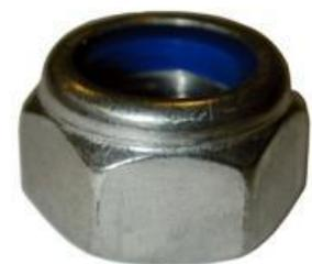
当动态载荷大到足以降低连接面的预紧力时，锁紧性能可防止螺母的脱落，但不能防止螺母在轻微旋转时进一步失去预紧力，预紧力一旦失去将无法复原。这可能导致连接件移位甚至最终疲劳失效。此外，当使用有效力矩型锁紧螺母时，需考虑重复使用性，重复使用将导致锁紧效果逐渐减弱。
