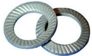
**Rip-Lock** 型带肋弹簧锁紧垫圈具有更大的外径，包含大间隙孔和腰形孔两种。螺钉头部或螺母位于脊状一侧的上端面。垫圈底面没有脊。垫圈的大直径在夹紧部位产生足够的摩擦力，防止垫圈转动。
