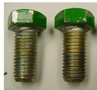
氢脆断裂经常是一种延迟失效的状态，而非发生在安装时，它可以在数小时甚至数周后发生。典型故障发生在安装后**24 - 48**小时内。最易发生在高性能等级公制**10.9**及更高、或英制**8**级及更高的螺纹紧固件上。表面硬化的螺纹部件也存在风险，例如螺纹成形自攻锁紧螺钉或锯齿螺钉，以及所有由弹簧钢制成的紧固件，如锁紧垫圈和挡圈。
